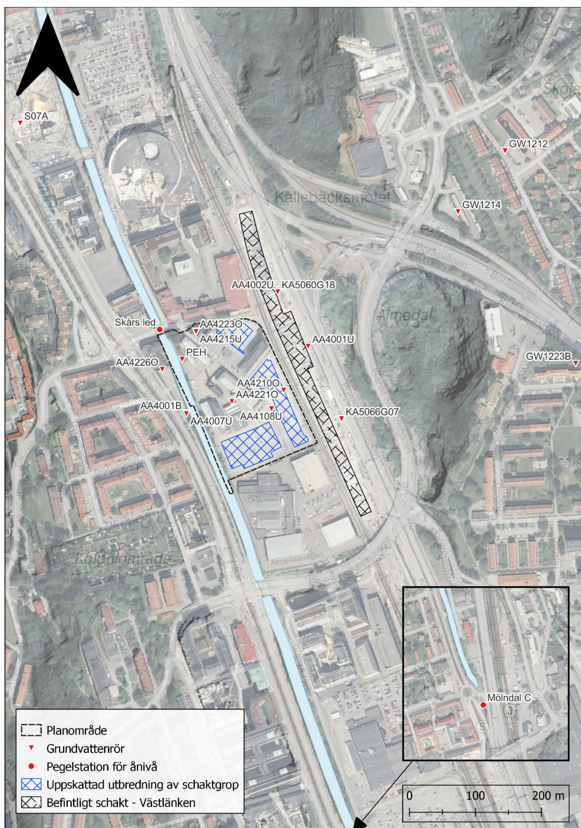
Figur 3-3 Observationsrör och peglar för nivåmätningar till kalibrering. Inklippt ruta visar pegelplats för Mölndalsån vid Mölndals centrum, söder om modellområdet.
